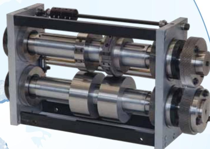
Gruppi di perforazione eseguiti su specifica richiesta del cliente e secondo le caratteristiche della macchina cui devono essere installati. Fustelle speciali per fori tondi, rettangolari e sagome di figure eseguiti per settore alimentare in genere. Il sistema di trasmissione del gruppo è sia in pollici che in millimetri, adattabile alla macchina da stampa cui è destinato.
